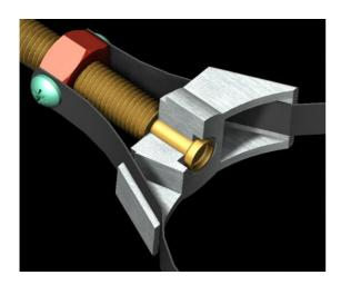
La vis de manoeuvre est montée sertie dans le mors, réalisant ainsi une liaison pivot (liaison par contact direct).
