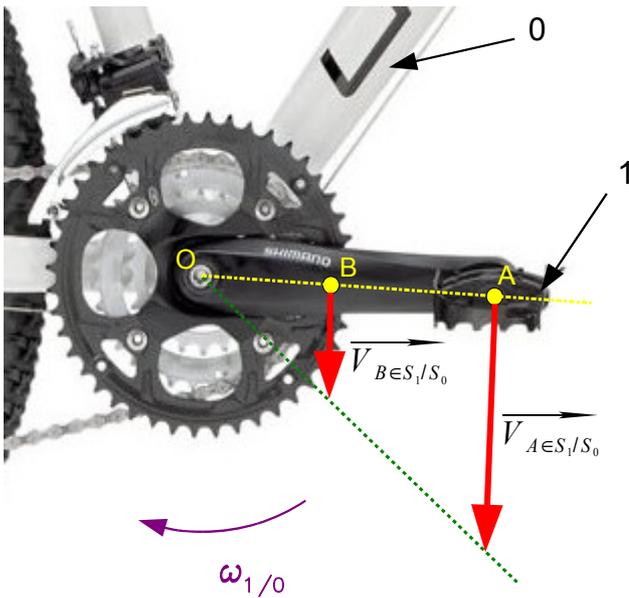
La vitesse instantanée d'un point appartenant à (1) varie en fonction de la fréquence de rotation et de la position du point par rapport au centre de rotation.
