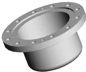
Génération d'un volume par la rotation d'un profil autour d'un axe (l'axe ne peut pas couper le profil)
