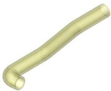
Génération d'un volume par le déplacement d'un profil le long d'un segment, d'une courbe plane ou 3D (le profil se déplace perpendiculairement à la courbe directrice)
