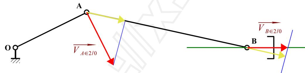
On trace une perpendiculaire à (AB) issue de l'extrémité de la projection en B qui coupe la direction du vecteur vitesse de  $B \in 2/0$
