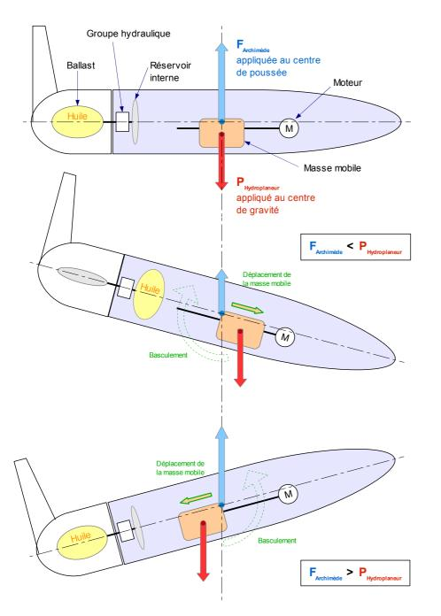
Par construction, le centre de poussée (CDP) et le centre de gravité (CDG) ne sont pas confondus.
